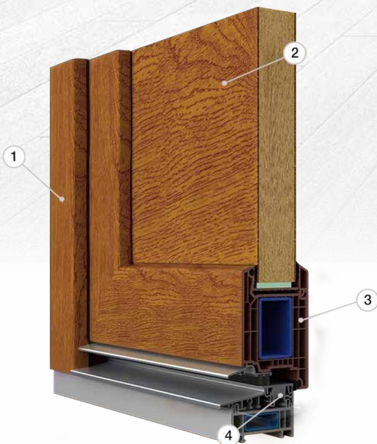
1 - Dormant | 2 - Panneau thermo-isolant ou le vitrage | 3 - Ouvrant | 4 - Seuil thermique en aluminium de 20 mm de hauteur avec un insert thermique.
